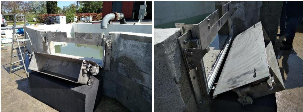
*Essais du prototype de clapet fusible au Pôle laboratoire de la SCP – avril 2021*
