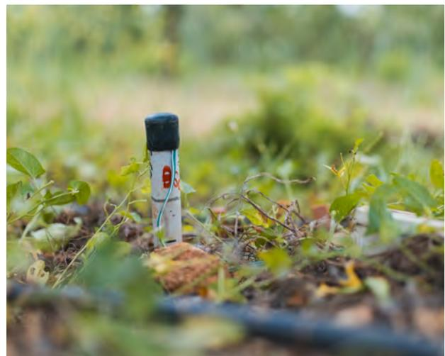
Exemple de capteur plante : tensiomètre © SCP
